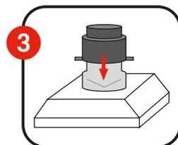
3 Le filtre se positionne sur la sortie d'air sur une réhausse cylindrique. Le filtre doit être imbriqué sur la réhausse sans utiliser les patins.
