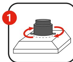
1 Tourner le filtre d'1/4 de tour, remplacer le filtre et retourner d'1/4 de tour dans l'autre sens.
