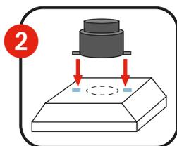
2 Si la surface est plane, le filtre se positionne directement sur la sortie d'air à l'aide des patins adhésifs.
